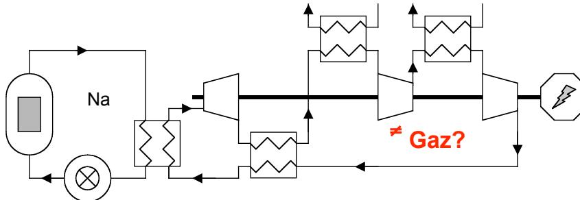
$T_{out\ core} = 550^\circ\text{C}$  (823K) ;  $T_{in\ turb} = 520^\circ\text{C}$  ;  $P_{in\ turb} = 50$  bar (5MPa)
