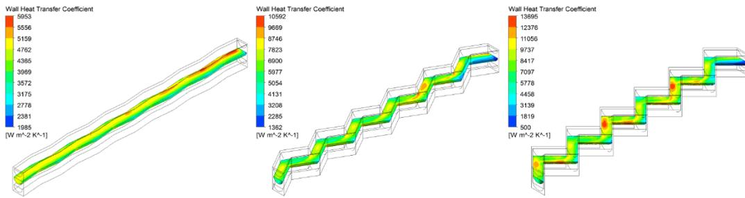
(a) 5°, 300kg/h, cold side      (b) 30°, 300kg/h, cold side      (c) 45°, 300kg/h, cold side
