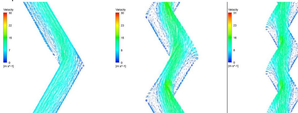
(a) 18mm×3, 300kg/h, cold side (b) 3mm×18, 300kg/h, cold side (c) 2mm×27, 300kg/h, cold side
