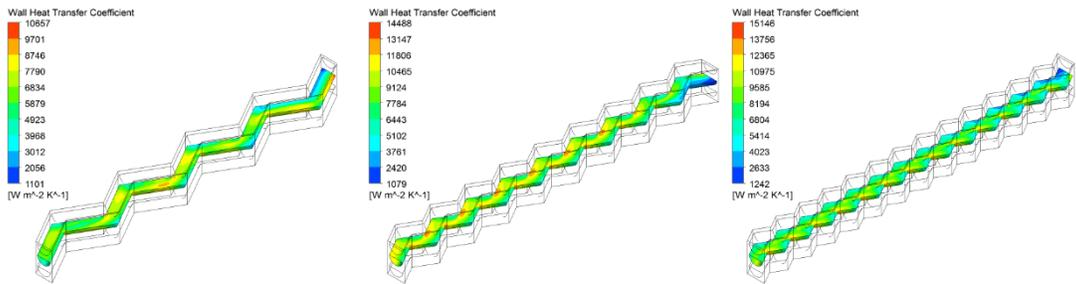
(d) 6mm×9, 300kg/h, cold side (e) 3mm×18, 300kg/h, cold side (f) 2mm×27, 300kg/h, cold side
