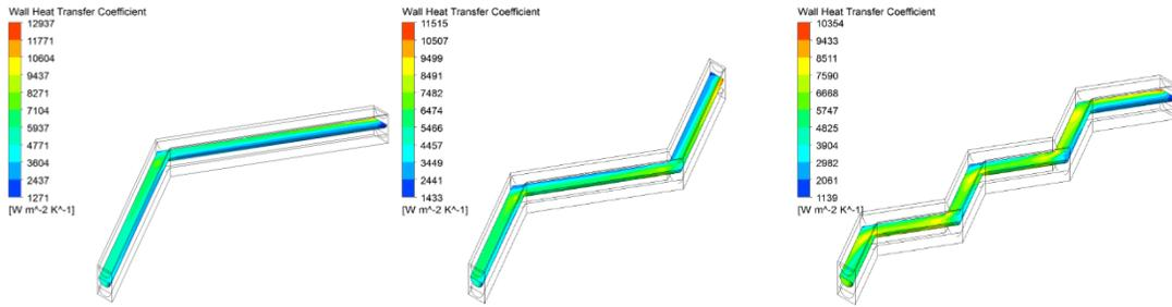
(a) 27mm×2, 300kg/h, cold side (b) 18mm×3, 300kg/h, cold side (c) 9mm×6, 300kg/h, cold side
